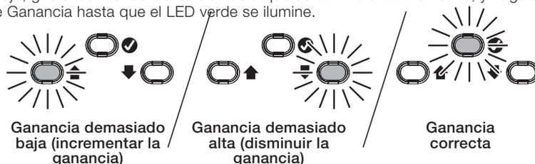
**NOTA:** Si sube totalmente el control de Ganancia y el LED amarillo sigue encendido, gire el control de Ganancia al "Min", ponga el conmutador de Nivel de Entrada en la posición "Low" y repita el Paso 6.
